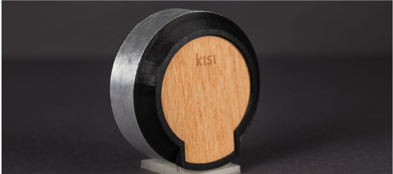
Die gesamte Elektronik, die Kisi benötigt, wird in dieser 3D-gedruckten Schale untergebracht.
